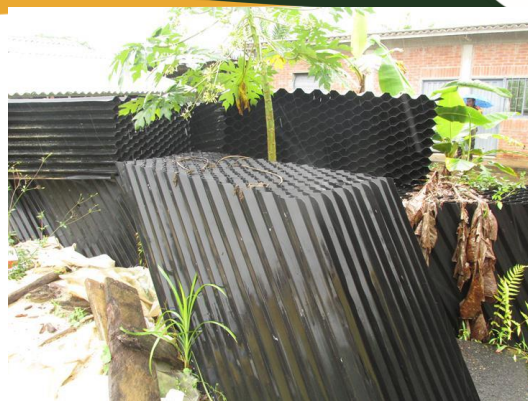
Foto 6. Módulos internos del floculador sin ser instalados y acopiados en el patio de la PTAP.
