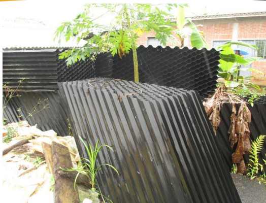
Foto 6. Módulos internos del floculador sin ser instalados y acopiados en el patio de la PTAP.
